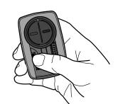
Ouvrir la télécommande. Tenir enfoncé le bouton de programmation jusqu'à ce que la DEL s'allume (environ deux seconds).
