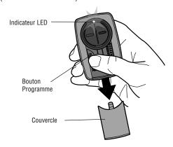
Enfoncer et relâcher le bouton. Lorsque le DEL cesse de clignoter, continuer d'enfoncer et de relâcher le bouton jusqu'à ce qu'un déclic se fasse entendre de l'ouvre-porte de garage, une lampe sur l'ouvre-porte de garage clignote, la porte de garage s'ouvre/se ferme ou un bip retentit de l'actionneur du portail (18 fois au maximum).
